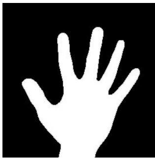
Gambar 6 Citra tangan yang telah mengalami proses thresholding .
