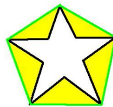
Gambar 2 Area yang berwarna kuning mewakili convexity defect (Muqtadir dkk., 2016).
